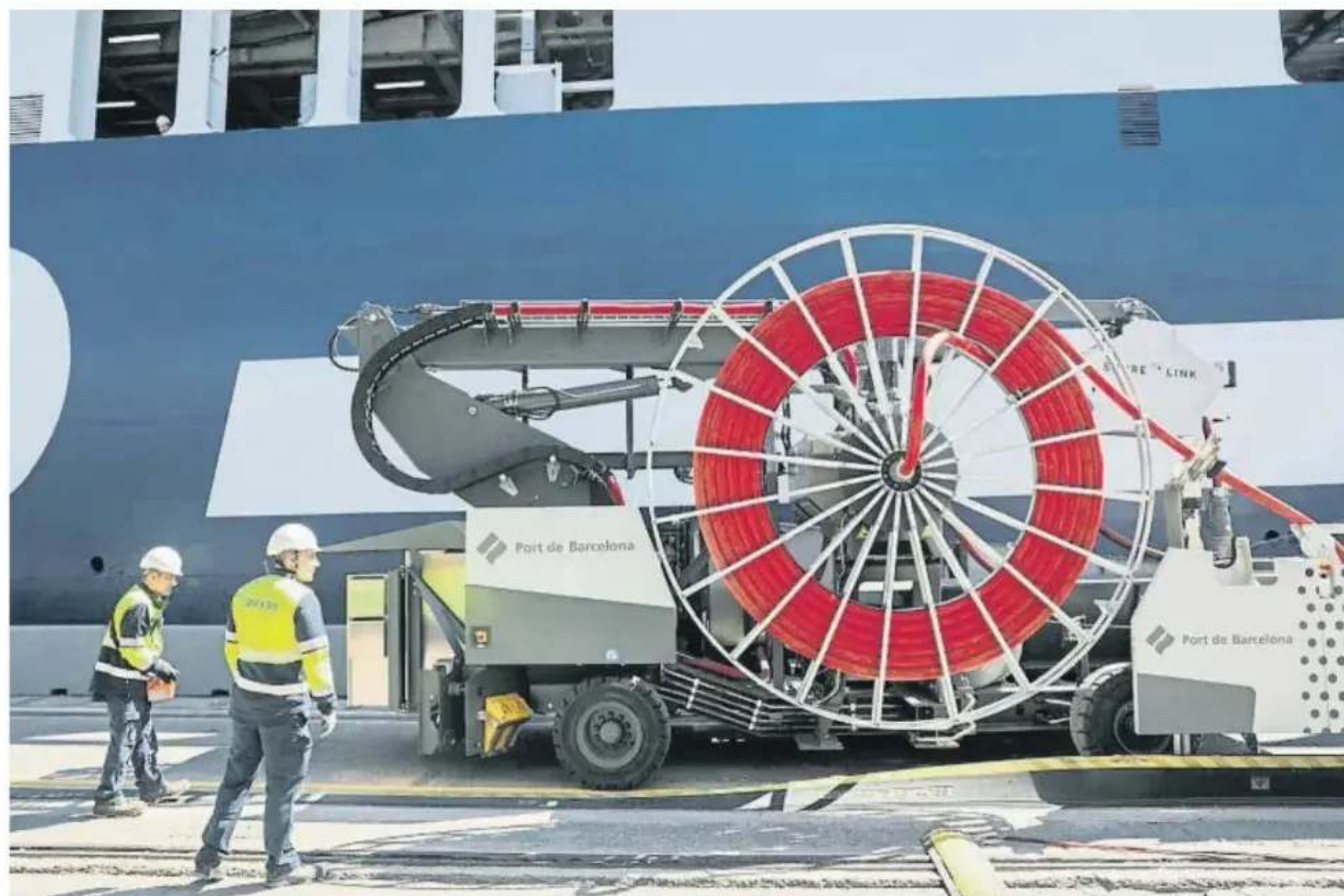
Conexión de uno de los ferrys de Grimaldi enchufado a un OPS para tener los motores apagados mientras está en el puerto
